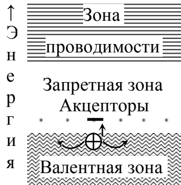
Рисунок 5.4 – Энергетическая диаграмма примесного полупроводника p -типа
