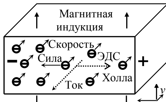
Рисунок 5.2 – Магниторезистивный эффект и поперечная ЭДС Холла
